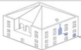
M19. COLLASSI LOCALI PER IRREGOLARITA' COSTRUTTIVE E DEL MATERIALE
